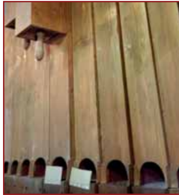
Die hölzernen Pfeifen des Subbass 16' - Pedal - → Registers unserer Orgel sind sowohl gedackt wie gekröpft. Unten die Aufschnitte der → Lippenpfeifen mit den Labien; Mit den Griffen am oberen Ende werden die Pfeifen gestimmt.
