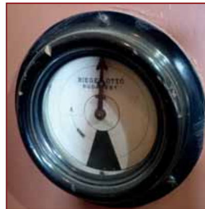
Das Manometer an unserer Orgel half dem Calcanten bei der Regulierung des Windes.
